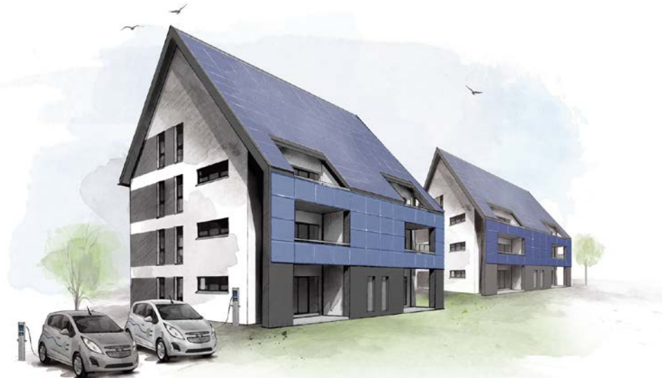
↗ Abb. 4: Miete mit Energieflat: Zwei vermietete energieautarke Mehrfamilienhäuser mit je 7 Wohneinheiten in Cottbus, Baujahr 2018, Solartechnik auf dem Dach und an den Balkonen erreichen zwischen 65 und 77 Prozent solare Deckung bei Strom und Wärme. Der Vermieter bietet dem Mieter für mehrere Jahre eine Pauschalmiete an, in der Wohnen, Wärme und Strom als Flatrate bereits enthalten ist.
